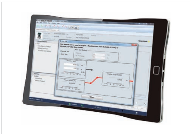
Obr. 2 FieldMate je najmodernejší nástroj na správu zariadení s podporou FDT2, ktorý podporuje vykonávanie úloh spojených s inteligentnými prevádzkovými prístrojmi, ako napr. kontrolu slučiek.
